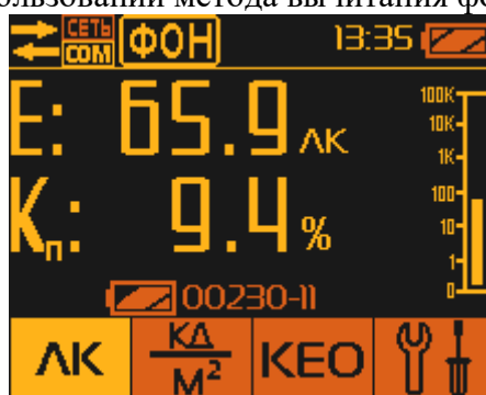
Рис.А.2.3.4.5-3. Показания прибора после вычитания фона с включёнными источниками света.
