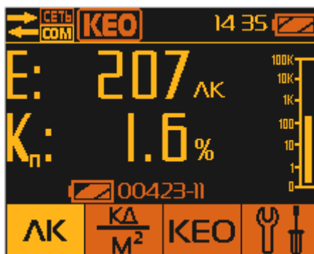
Рис.А. 2.3.6.1-6. Измерение освещённости с КЕО.
